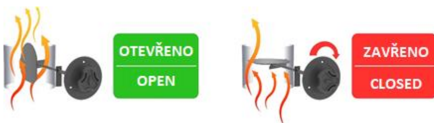
Schéma III – 2.2. Ovládaní klapky kouřovodu
